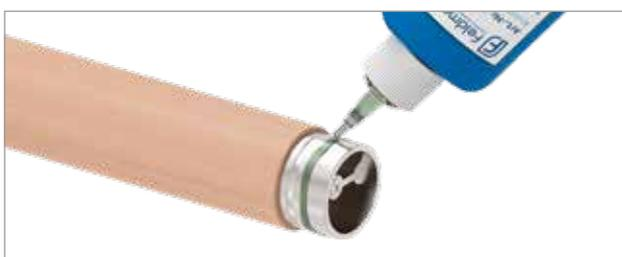
**5. SCHRITT:** Auftragen eines Metallklebers (z.B. 7080-K) auf den Adapter.
