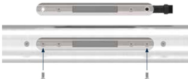
**Schritt 3:** Verbinden Sie das Kabel des Moduls mit dem Y-Kabel. Verschrauben Sie das Modul mit den Nutsteinen (M3x6 mm). Verschließen Sie am letzten Modul das offene Ende des Y-Kabels mit der Endkappe.
