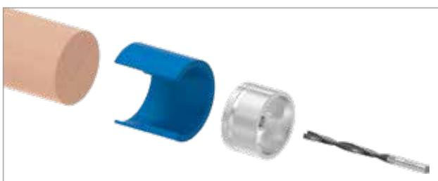
**1. SCHRITT:** Bohrlehre (50606-240) auf den Holzhandlauf setzen und den Adapter (50605-240) in die Bohrlehre schieben.
