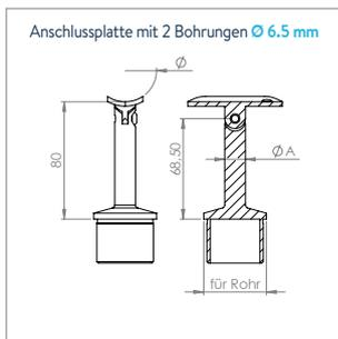
**Handlaufstütze mit Anschlussplatte und Gelenk**
