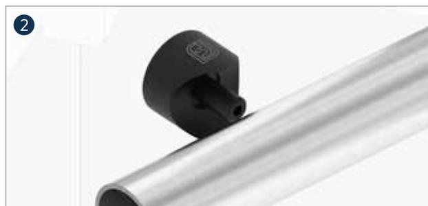
**Schritt 2:** Werkstück und Ausrichthilfe zusammenstecken.
